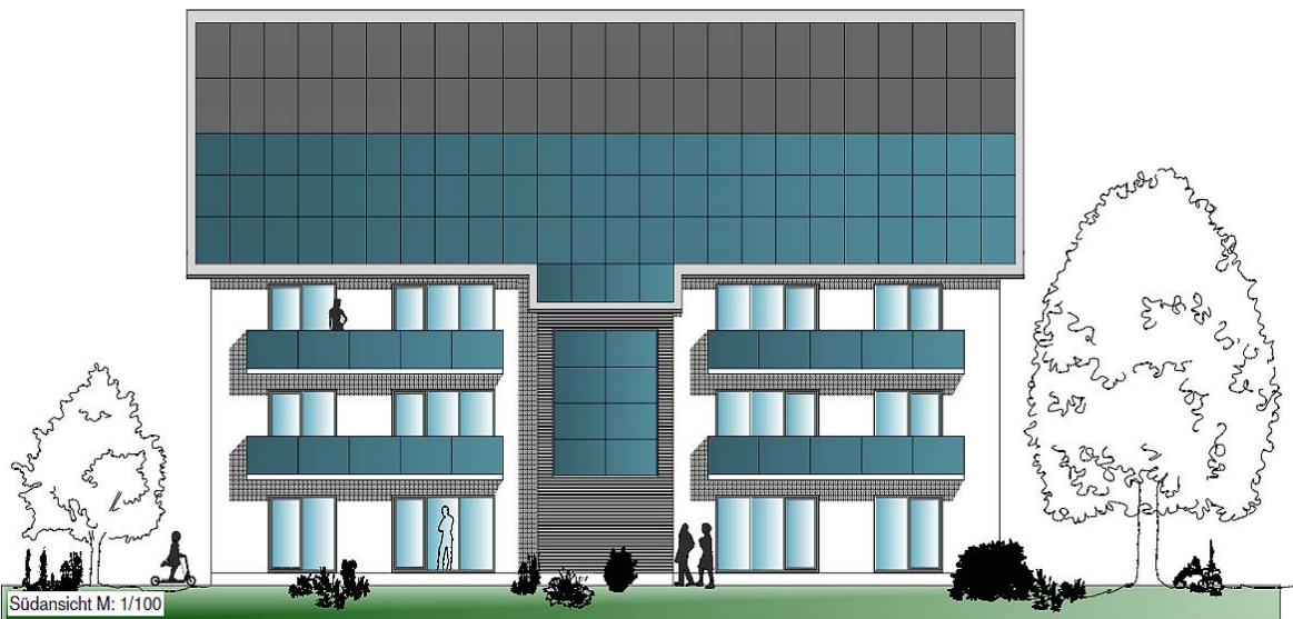
Abb. 12: Miete mit Energieflat: Energieautarkes Mehrfamilienhaus mit 6 Wohneinheiten in Wilhelmshaven, Baubeginn geplant 2017. 96 m 2 Solarthermie mit 19 m 3 Langzeitwärmespeicher sowie 28 KWP Photovoltaik auf dem Dach und an den Balkonen mit 54 kWh Akku erreichen rund 70 % solare Deckung bei Strom und Wärme. Der Vermieter kann dem Mieter für mehrere Jahre eine Pauschalmiete anbieten, in der Wohnen, Wärme, Strom und E Mobilität als flatrate bereits enthalten ist.
