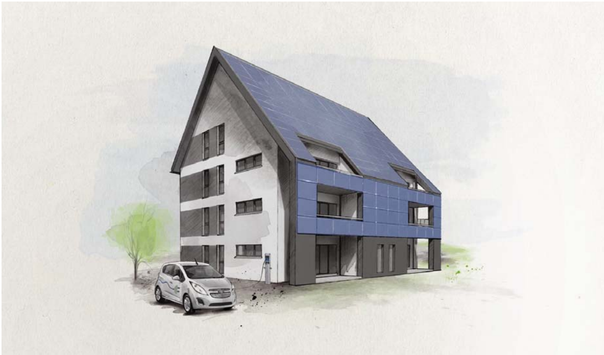
Abb. 11: Miete mit Energieflat: Zwei energieautarke Mehrfamilienhäuser mit je 7 Wohneinheiten in Cottbus, Baubeginn geplant 2017. 100 m 2 Solarthermie mit 25 m 3 Langzeitwärmespeicher sowie 30 KWP Photovoltaik auf dem Dach und an den Balkonen mit 54 kWh Akku erreichen zwischen 65 und 77 solare Deckung bei Strom und Wärme. Der Vermieter kann dem Mieter für mehrere Jahre eine Pauschalmiete anbieten, in der Wohnen, Wärme, Strom und E Mobilität als flatrate bereits enthalten ist.
